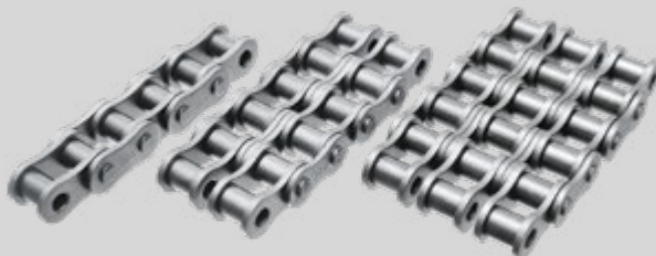
Válečkové řetězy s projmutými destičkami ISO 606 (DIN 8187, DIN 8188) a podnikové normy – jednořadé (simplex), dvouřadé (duplex) nebo třířadé (triplex)
