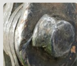
Svar se při praktickém použití rozlomí
