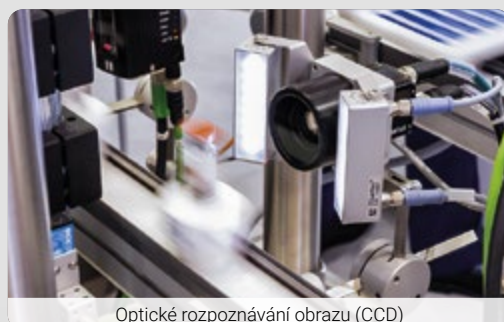
Optické rozpoznávání obrazu (CCD)
